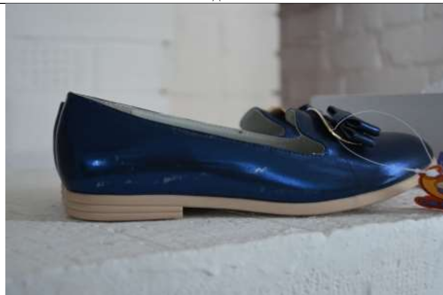
Фото 40. Механическое повреждение внешней части туфли (потертость)
