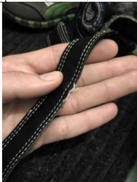
Фото 75. Низкое качество швов
