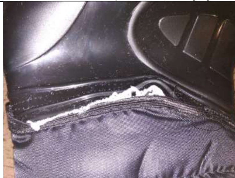
Фото 84. Низкое качество шва
