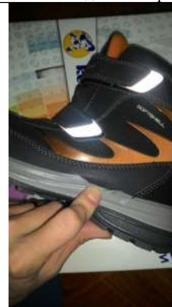
Фото 56. Отслоение подошвы ботинка
