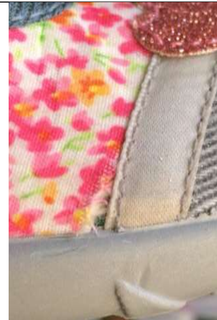
Фото 70. Низкое качество швов
