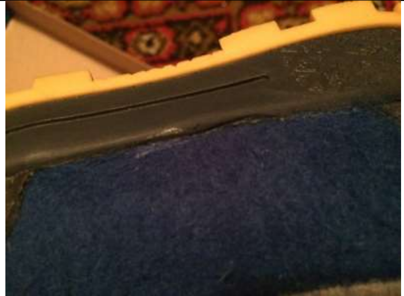
Фото 50. Отслоение подошвы от ботинка
