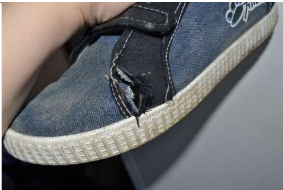
Фото 39. Рваное повреждение внутренней части ботинка
