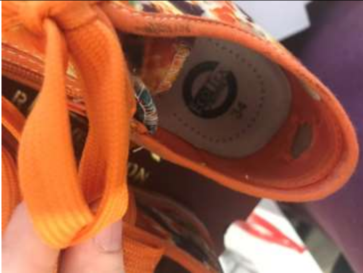
Фото 1. Механическое повреждение внутренней части ботинка
