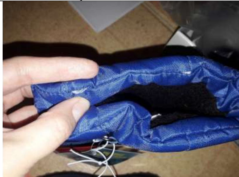
Фото 27. Некачественно выполненные швы
