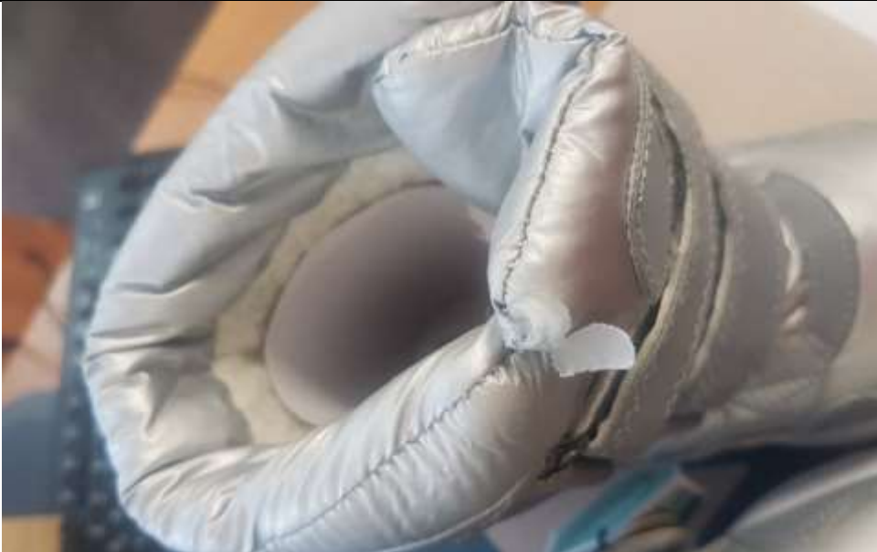
Фото 33. Механическое повреждение внутренней части ботинка
