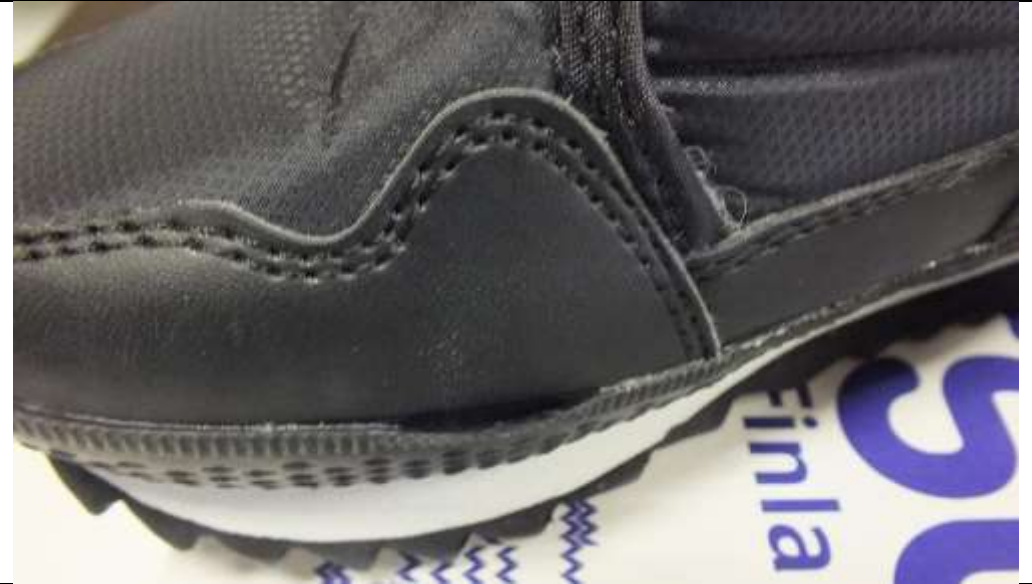
Фото 10. Необработанный шов, повреждение подошвы и внешней стороны ботинка
