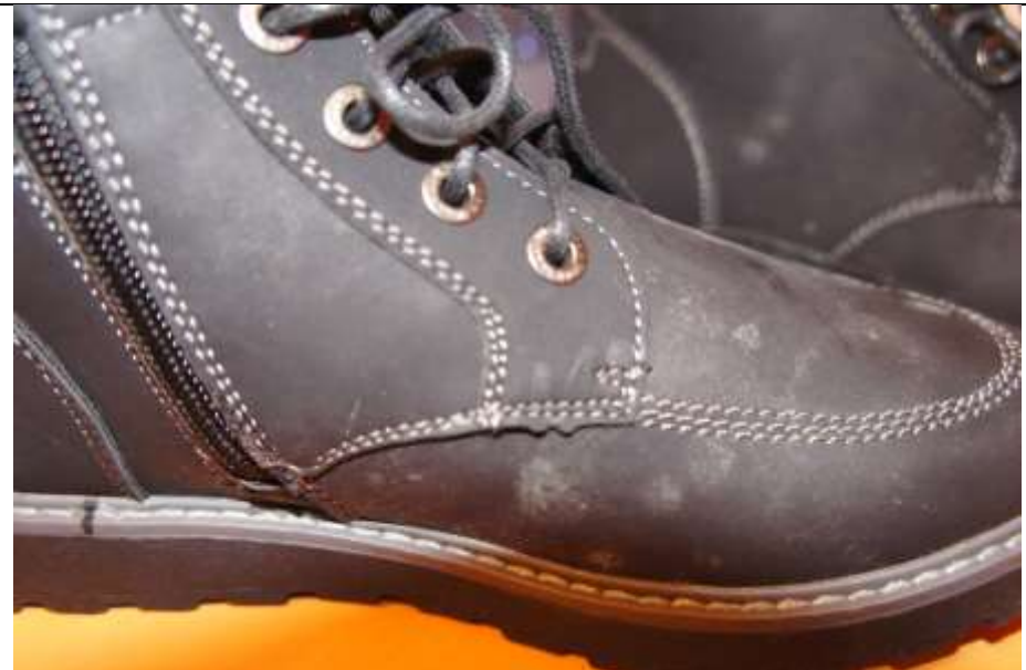
Фото 42. Механическое повреждение внешней части ботинка (потертость)
